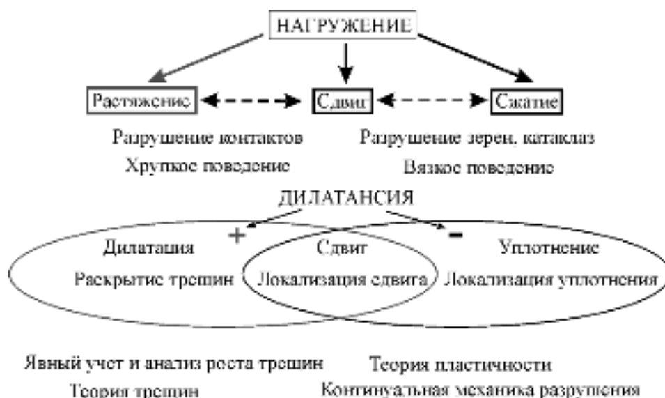
Рис. 1. Схема явлений, наблюдаемых в плотных и высокопористых геологических средах при различных условиях нагружения
